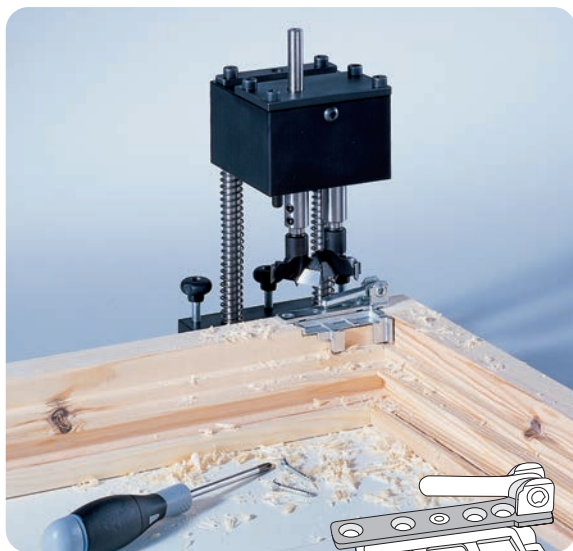
Fixing of edge hinge
